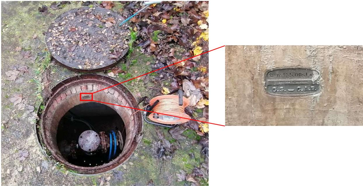
Figura 20 Misurazione del livello statico dell'acqua di falda presso il pozzo 0150120006, con zoom relativo alla targhetta segnalatrice di quota del piano campagna (in m s.l.m.)
